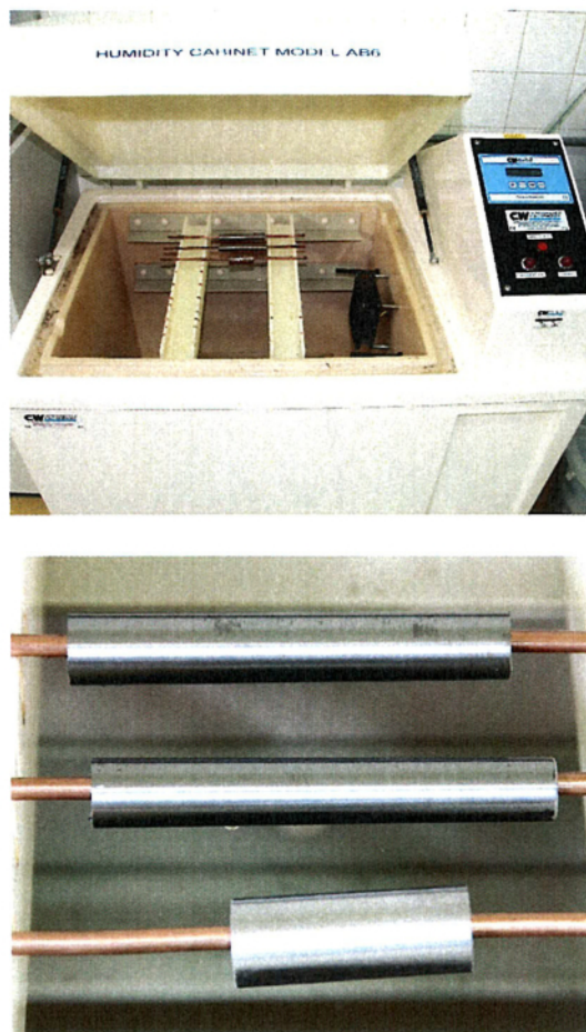
Slika 2. Prikaz uzoraka u vlažnoj komori, početak ispitivanja. Donji uzorak na slici je kontrolni nezaštićeni uzorak.
